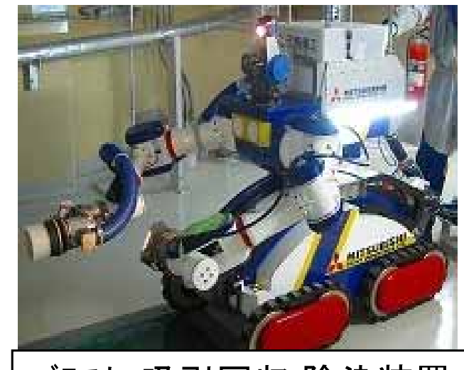
ブラスト・吸引回収 除染装置
