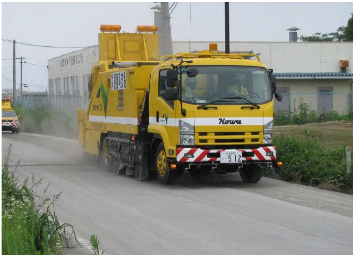
路肩清掃中の様子
