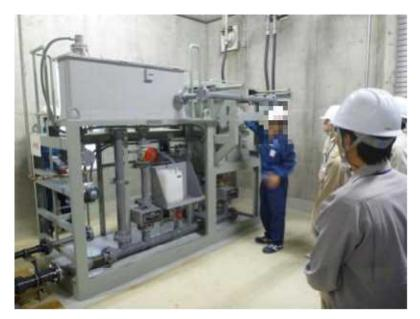
・放水口からくみ上げた排水 を N a I (T I)シンチレーション検出器で測定。
