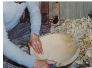
仕上げ (サンドペーパーをあてて仕上げる)
