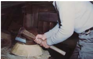
外側荒削り (オノで外側から削る)
