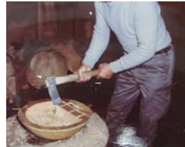
内側荒掘り (外側を仕上げしてから内側を掘る)
