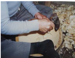
仕上げ掘り (テブリと呼ばれる手斧で底に向けて規則正しく削り込む)
