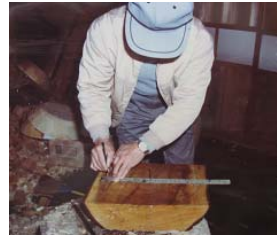
墨付け (板取した盤に墨付けをする)
