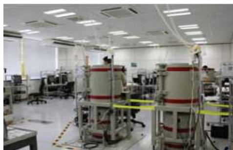
⑨ ゲルマニウム半導体分析器で計測する
