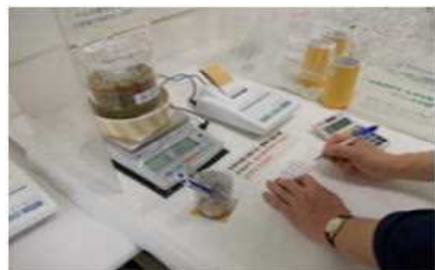
⑦ 電子天秤で試料の重量を測定する
