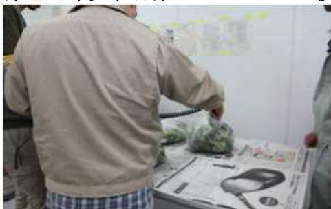
①試料を調整する前にサーベイメータにより放射能レベルを確認
