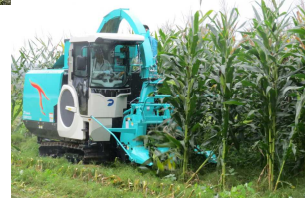
稲WCSと飼料用とうもろこし専用収穫機による 収穫・調製作業
