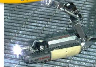
2号機格納容器内調査ロボット
