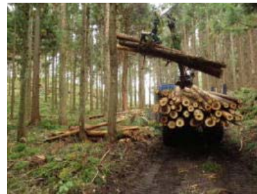
林内作業路整備支援事業により開設した 作業路を利用した間伐材の搬出（会津）
