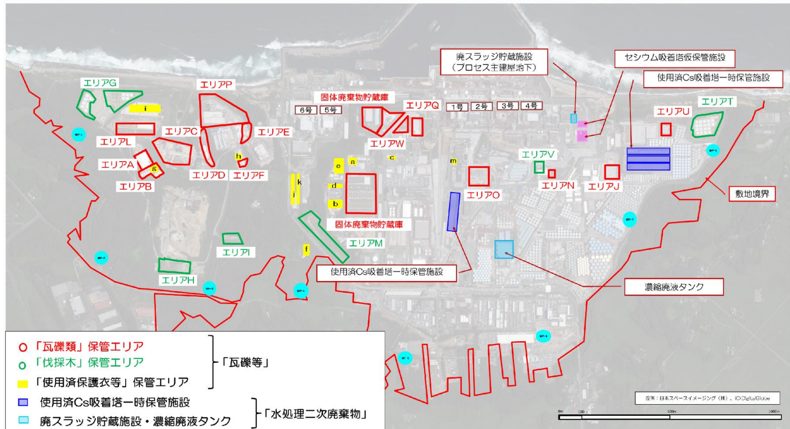
福島第一原子力発電所構内における「瓦礫等」及び「水処理二次廃棄物」の保管状況
