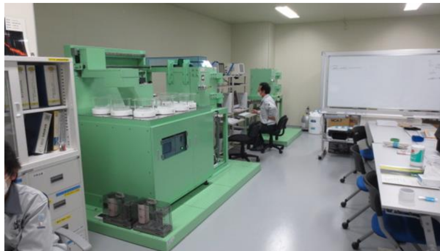
JAEAにおいて測定に使用した電気冷却式Ge半導体検出器
