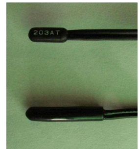
図1 樹脂製の汎用センサー
