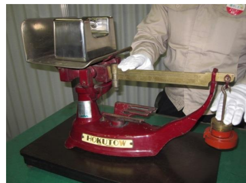
定期検査(皿手動はかり)
