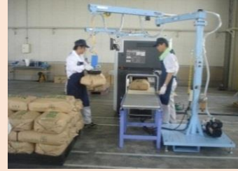
全量全袋の検査の様子
