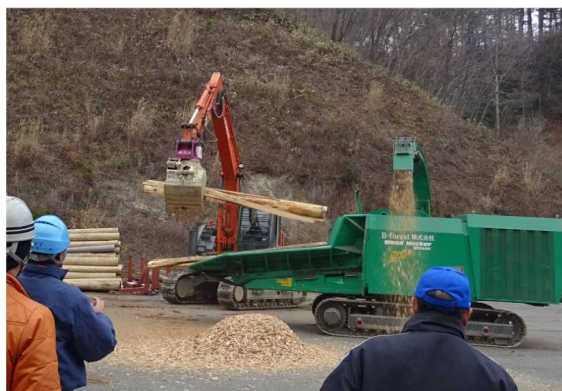
移動式チップーによるチップ製造のデモ
