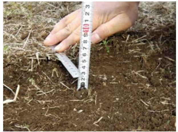
図4 剥土作業後の剥土した深さを測定している様子
