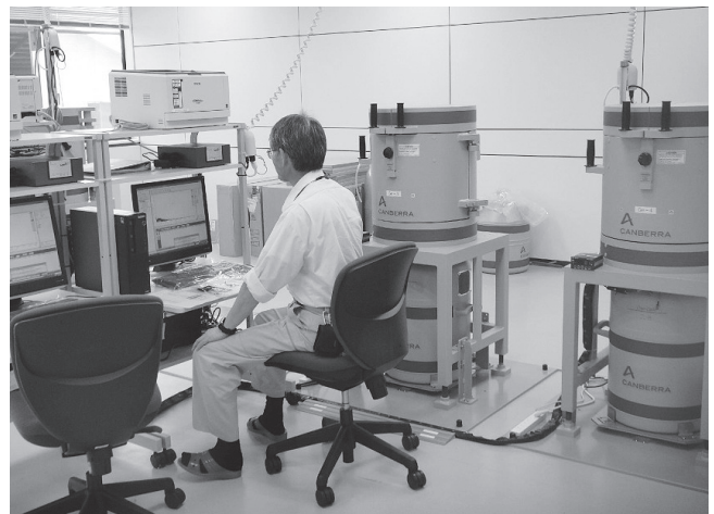
図1 ゲルマニウム半導体検出器による農林水産物の放射性物質分析の様子
