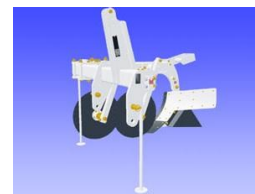
溝切機(スガノ農機DP201)による額縁明渠を設置
