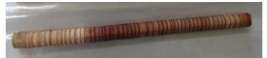
成長錐を利用した材の採取(上)と採取した材サンプル(下)
