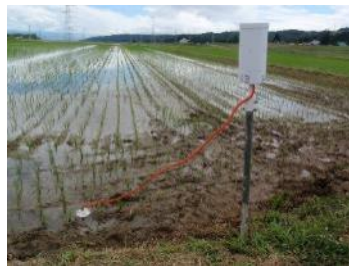
水田センサーによる水管理
