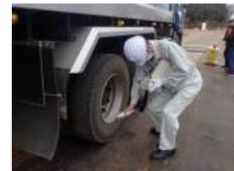
車両周辺の空間線量率測定
