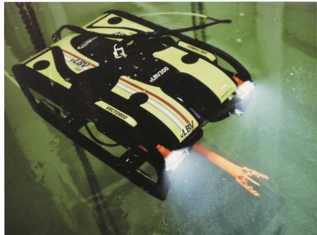
【廃炉作業を行う無人作業機器】
