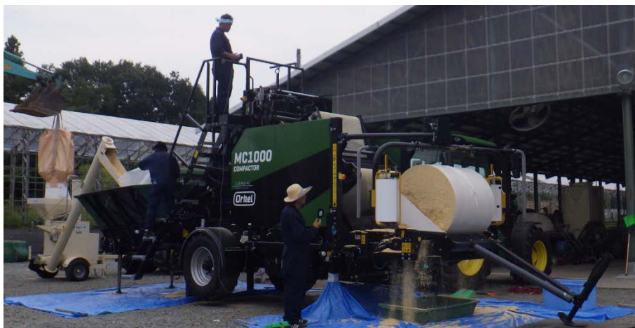
図1 サイレージ調製の様子(左:破砕機、右:マルチコンパクター)
