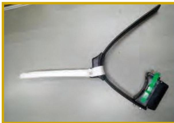
アンテナ欠損の課題に対して、アンテナカバーを取り付けることにより、首輪脱落までGPS首輪の追跡を可能にした。
