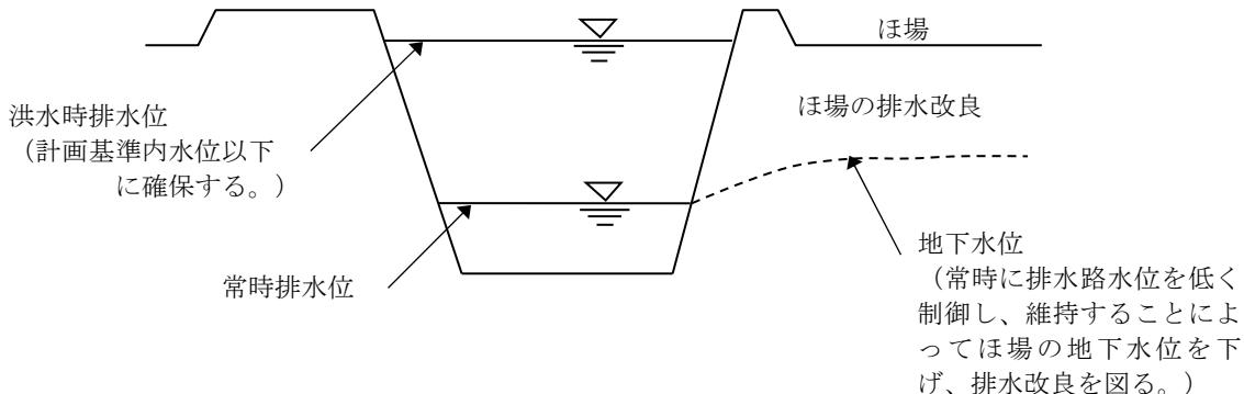
図-1.3.2 洪水時排水と常時排水の概念図
