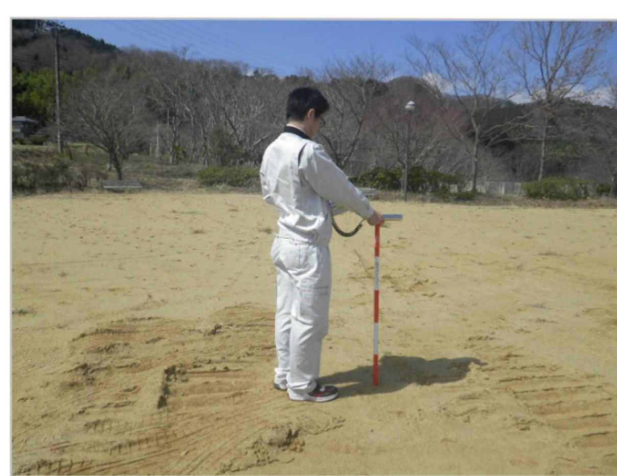
サーベイメータによる測定
