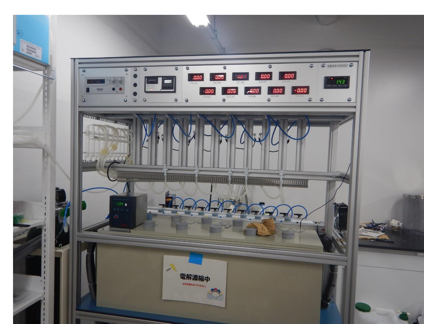
トリチウム電解濃縮装置
