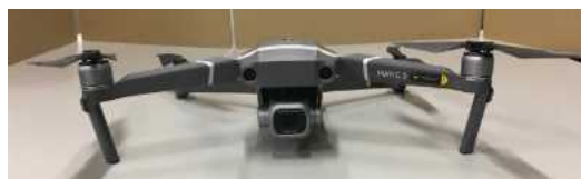
電動マルチローターヘリコプター Mavic 2 Pro 大きさ(cm)縦×横×高さ:50×60×10
