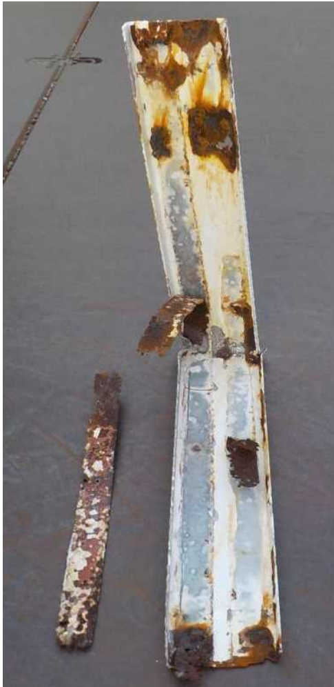
落下した足場材
