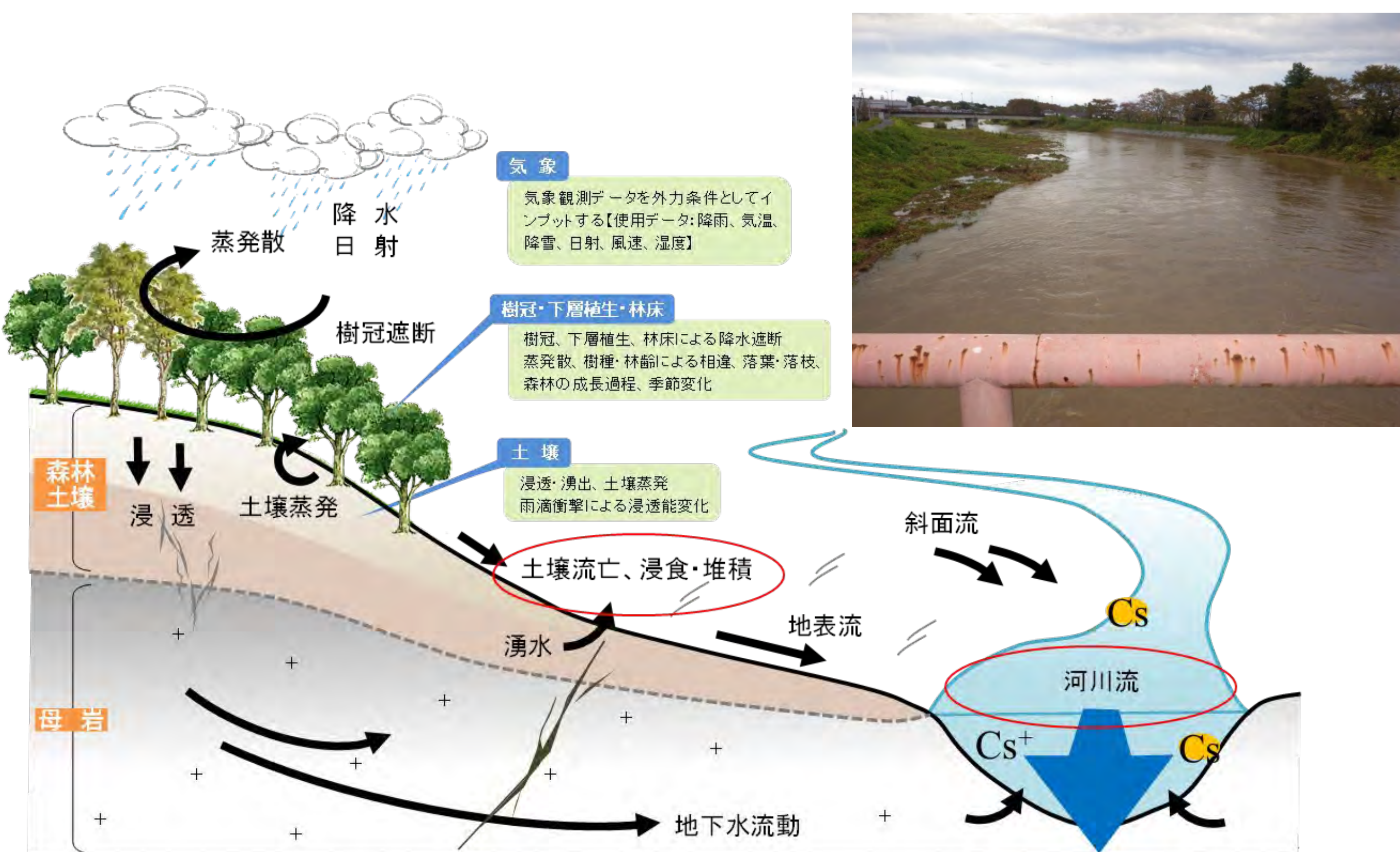
セシウムを土砂に付着させ、水・土砂流出を計算する
