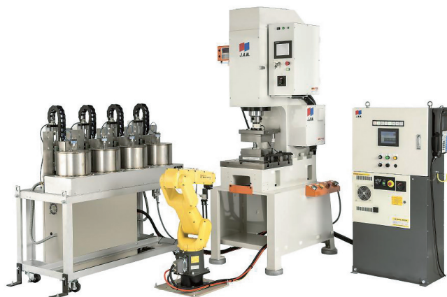
材料加熱炉 ワーク搬送ロボット 精密小型プレス 制御盤
