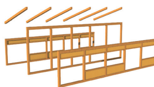
有開口耐力フレームイメージ図
