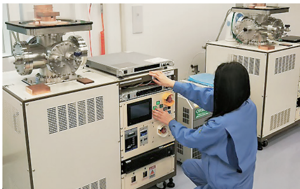
電子発生源（エミッター）の電気特性試験
