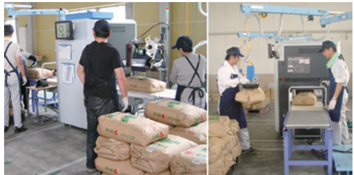
ベルトコンベア式検査機器による全量全袋検査
