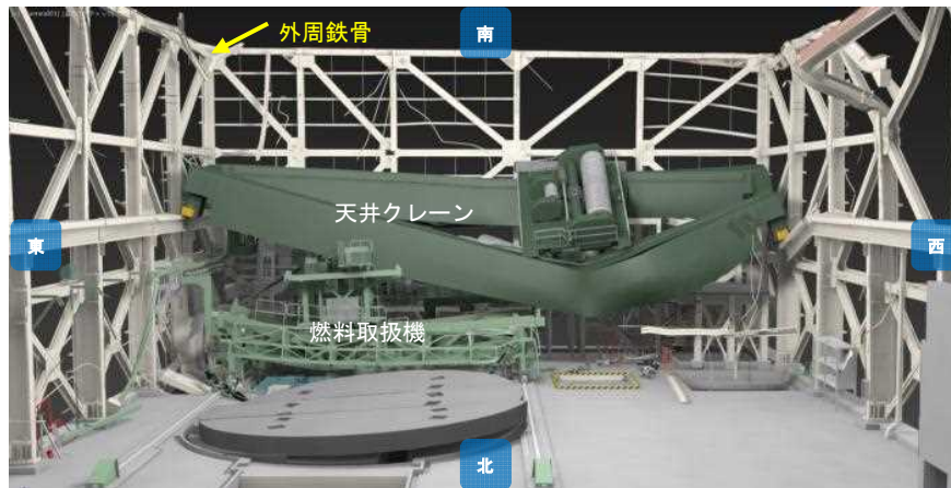
天井クレーン・燃料取扱機のイメージ図 (3Dスキャン結果と写真を基に作成、配置図A方向)
