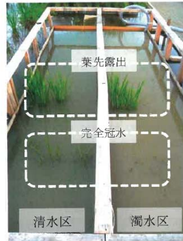
図-5.5 冠水試験中の様子 (手前が最深部)
