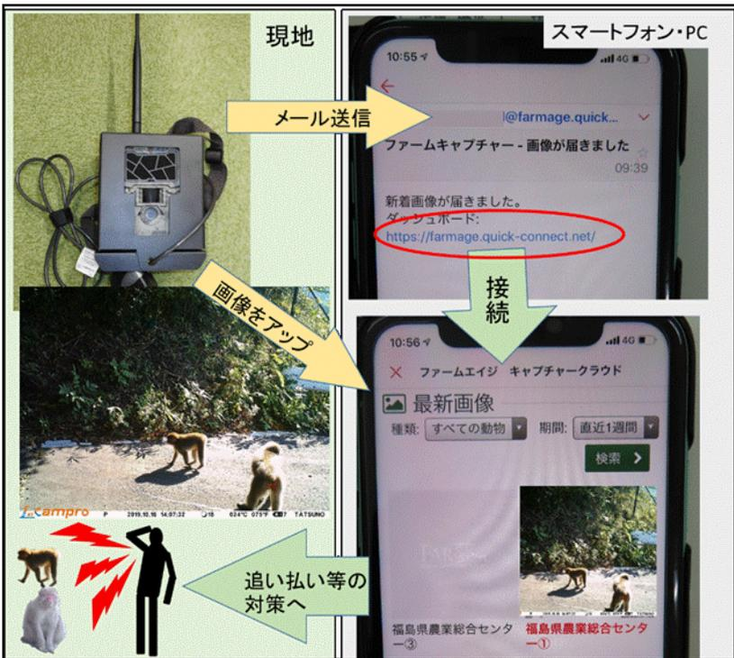
図1 IoT赤外線センサーカメラ撮影時のデータ確認
