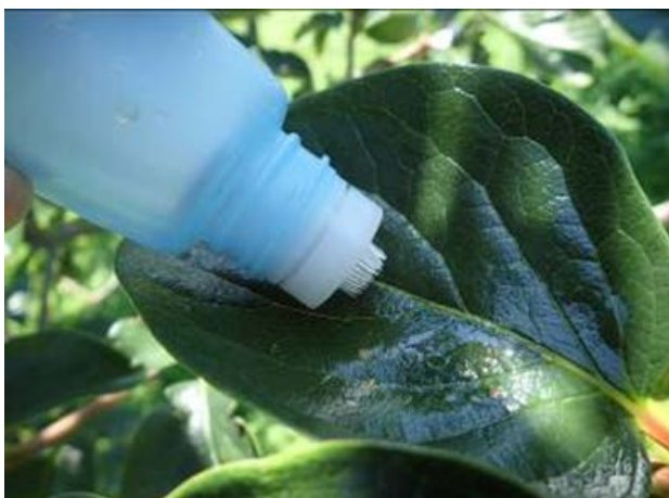
図 7.6 ^{137}\text{Cs} 液塗布処理
