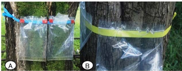
図 6.7 プラスチックバッグによる幹流水の直接捕集
