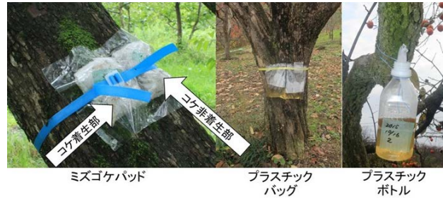
図 6.14 幹流水捕集装置の設置状況 (伊達市カキ園・無洗浄樹)
