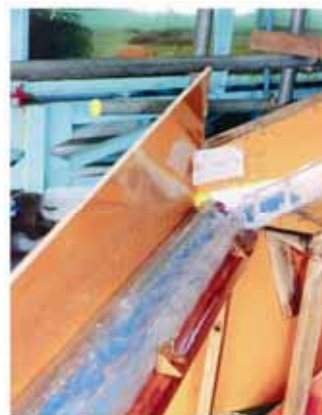
図-20.17 らせん流方式水路 (屈曲角度 45°)
