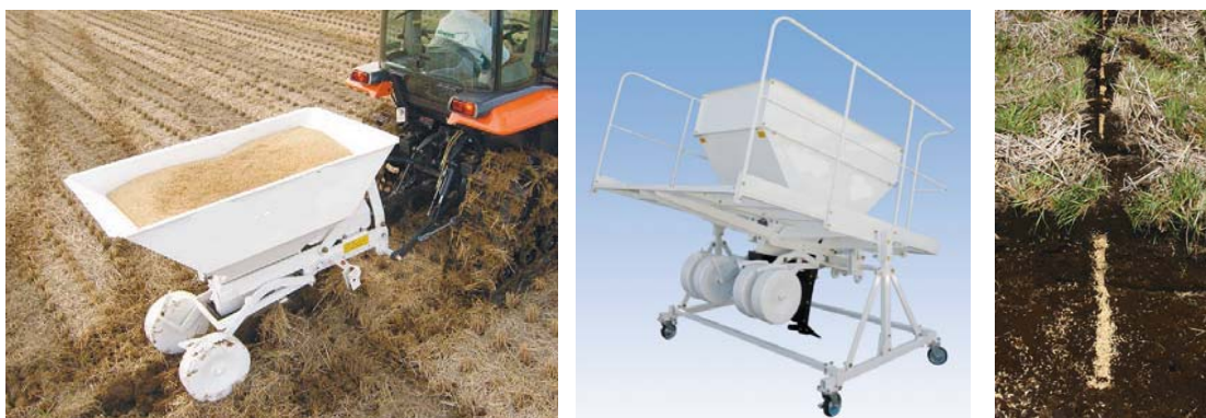
写真-29.1 疎水材心土充填機によるモミガラ補助暗渠工法
