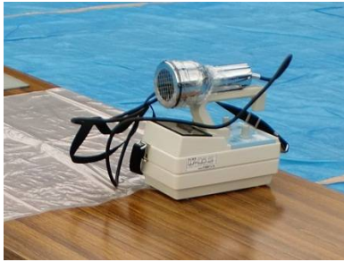
検査に使用した GM計数管式サーバイメータ
