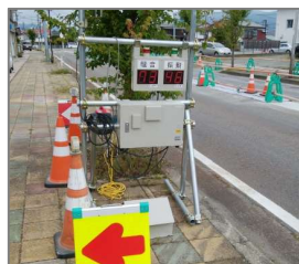
市街地内のCo取り壊し作業のため、騒音・振動計を設置した
