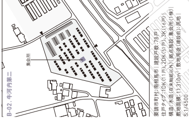
B-02 牛河内第二 建設戸数: 78戸 住戸タイプ: 1DK(11戸), 2DK(55戸), 3K(12戸) 構造: 木造(在来軸組以外) | 仮設施設(建設戸数) 敷地面積: 11,310㎡ | 敷地面積(建設前): 公有地(公園・運動場) | S:1/4500
