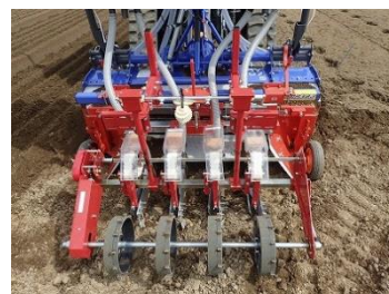
図1 ベルト式播種機(BS-4WUS：(株)向井工業)
