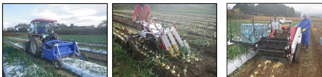
図 5 葉切り → 収穫機で根切り → ピッカーで回収
