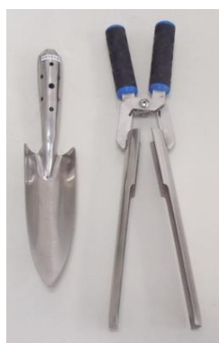
図1 省力型採土器の現物写真とイメージ図
