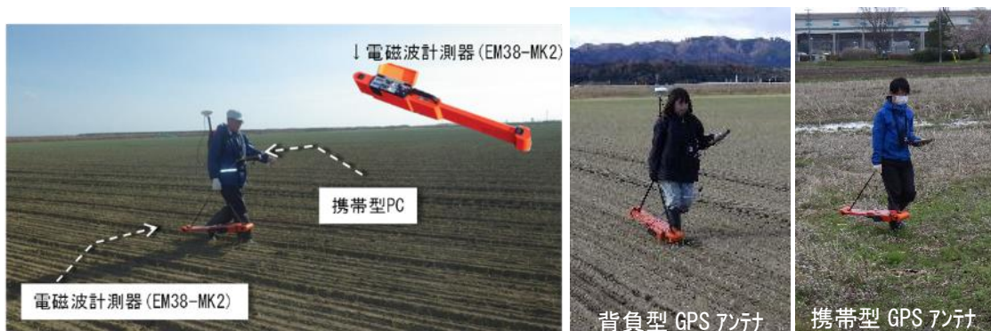
図2 電磁波計測器を用いた歩行計測（水平モード）による下層土の土壤水分計測（通常の歩行速度で、ほ場畦畔に沿って約15m間隔で往復しながら計測）
