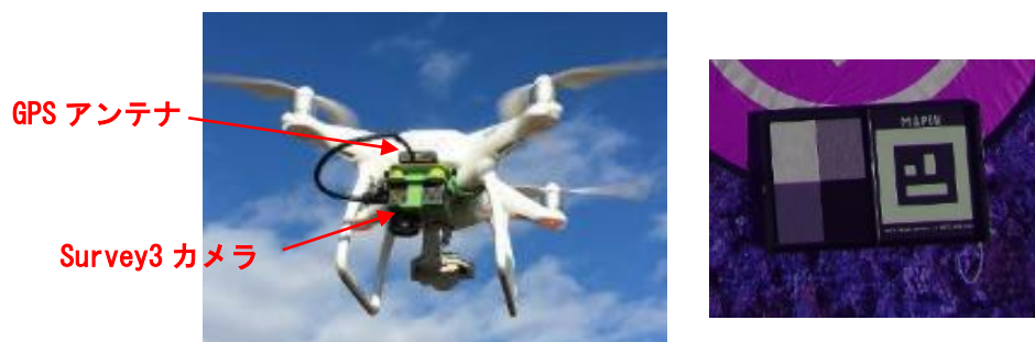
図1 Survey3 カメラを取り付けた Phantom4 (左) 及び付属品の標準反射板撮影画像 (右)
