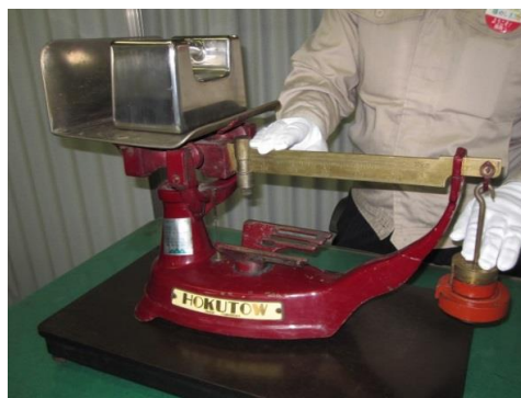
定期検査(皿手動はかり)
