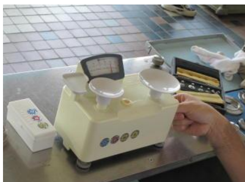
定期検査(手動指示併用はかり)
