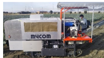
図1 ブロッコリー選別自動収穫機
