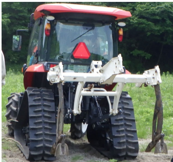
図1 トラクタ(60ps)に装着したサブソイラ
