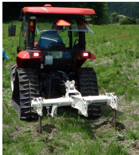
図2 サブソイラによる心土破碎
