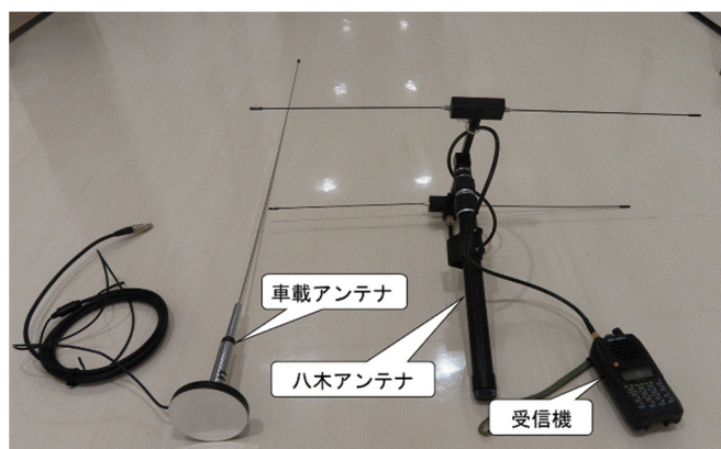
図2 調査に使用した機材（車載アンテナ、八木アンテナ、受信機）
