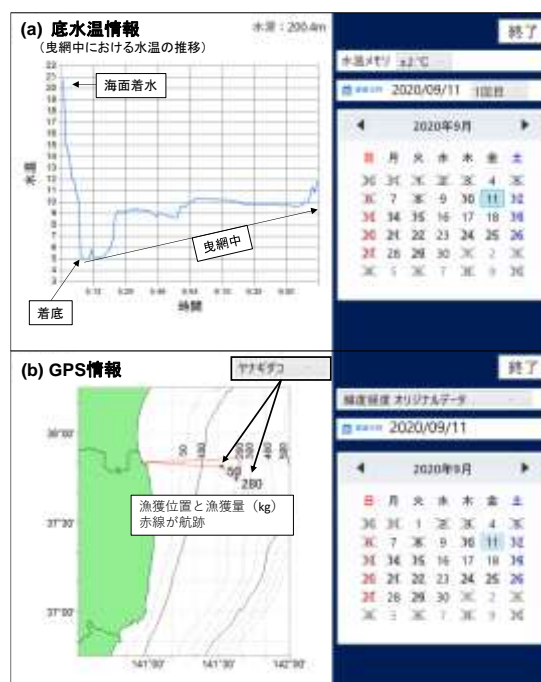
図 2 タブレットに表示される (a) 底水温情報, (b) GPS 情報
