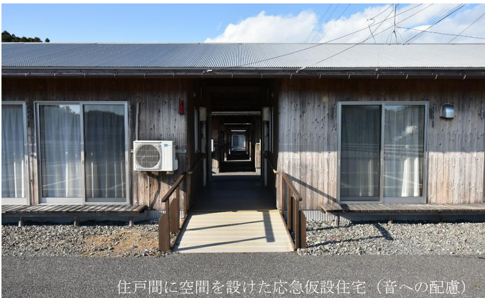
住戸間に空間を設けた応急仮設住宅（音への配慮）
