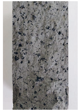
IGCC スラグ混合状況
