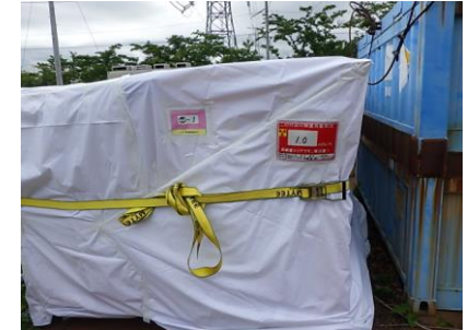
養生・線量表示実施後のコンテナ
