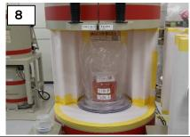
8 QRコードにより試料情 報をゲルマニウム半導体検 出器に取り組み、測定を行 います。
