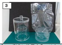
3 測定に使用するマリネリ 容器0.7 ぱ(左)、容器の 汚染防止に使用する専用の 内袋(右)
