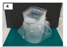
4 容器に試料が触れないよ うにするため、マリネリ容 器に内袋と外袋をセットし ます。
