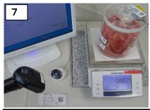
7 試料の重量を測定します (U-8容器使用時は充填 した試料の高さも測定しま す)。
