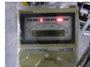
仮設灰処理施設(その2)線量測定
